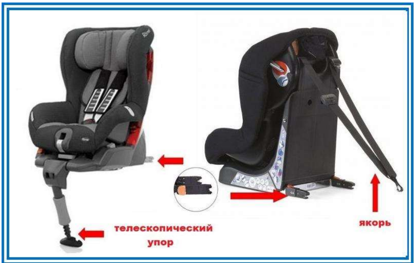
Рисунок 6. Телескопический упор и якорное крепление
