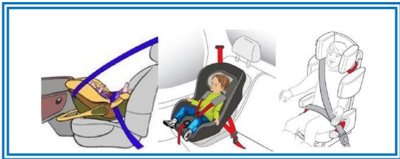
Рисунок 4. Крепление штатными ремнями безопасности
