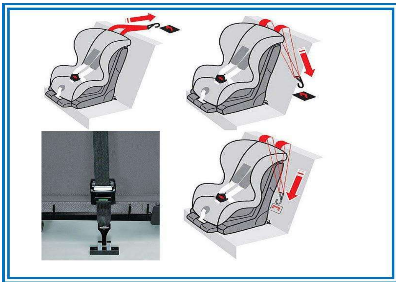
Рисунок 7. Способы фиксации якорного крепления
